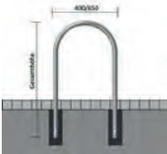
**Rundbügel, zum Einbetonieren**
